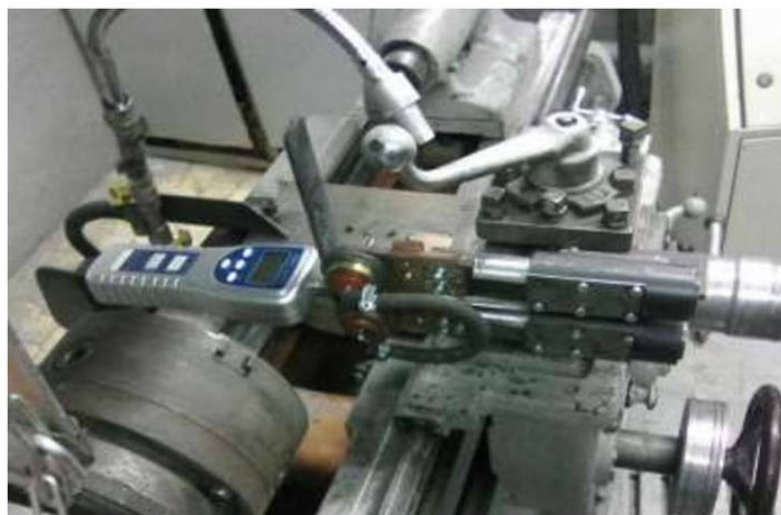
Рисунок 2.18 – Измерение создаваемой нагрузки на инструментальной головке
