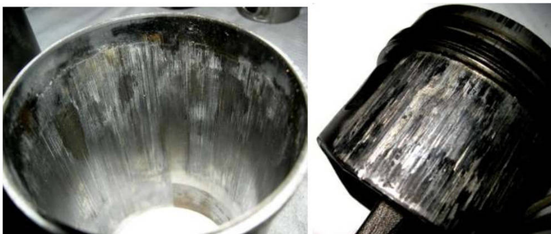
Рисунок 1.1 – Износ при схватывании цилиндропоршневой группы дизельного двигателя
