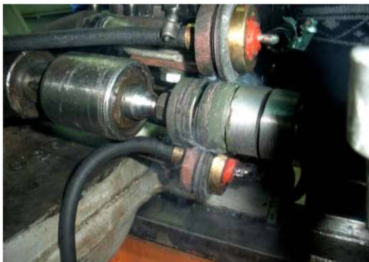
Рисунок 4.2. Процесс имплантации карбида вольфрама.
