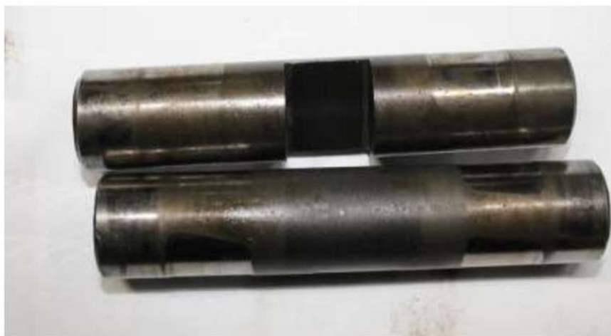
Рисунок 2.4 – Ось сателлита дифференциала
