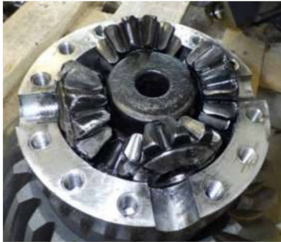
Рисунок 1.17 – Внешний вид разрушенного дифференциала первого ведущего моста грузового автомобиля.
