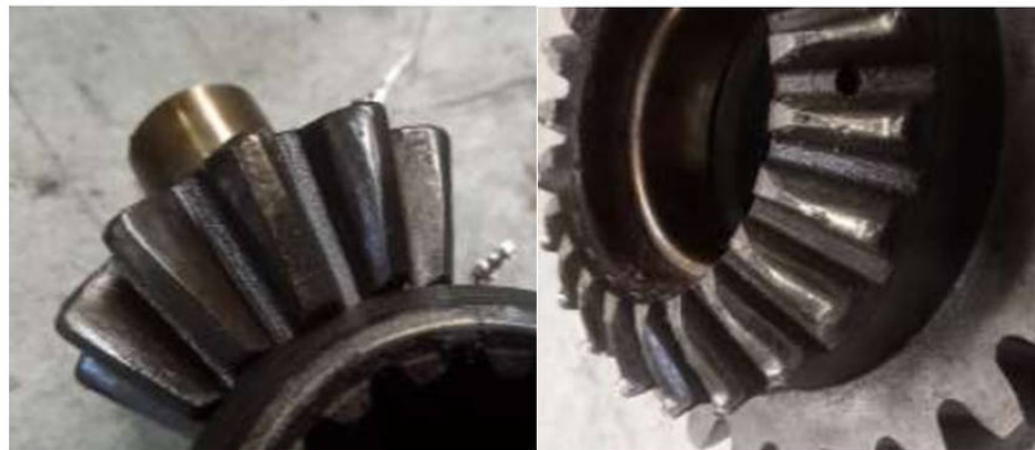
Рисунок 1.20 – Смещение пятна контакта в зацеплении шестерни и пластическая деформация зубьев шестерни полуоси.
