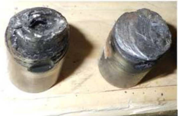
Рисунок 1.18 – Разрушение всех осей крестовины сателлитов дифференциала первого ведущего моста.
