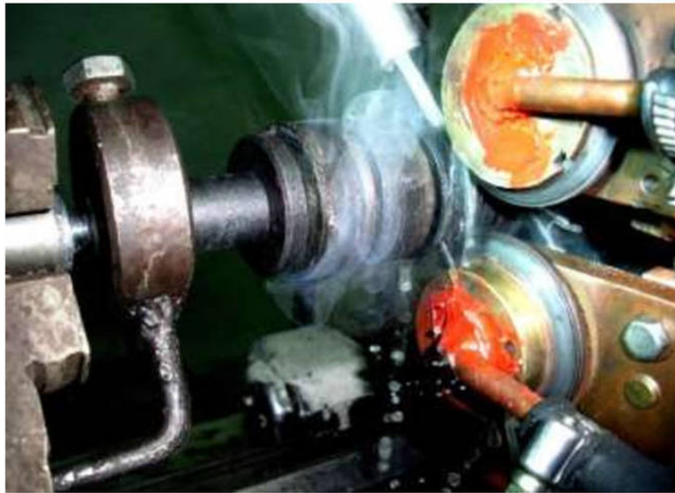
Рисунок 4.3. Упрочнение при ЭМО.
