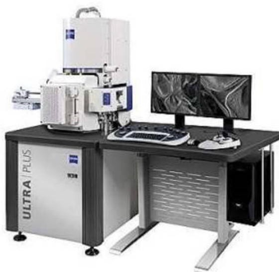
Рисунок 2.11 – Автоэмиссионный сканирующий электронный микроскоп сверхвысокого разрешения Zeiss Ultraplus на базе Ultra 55 , Германия
