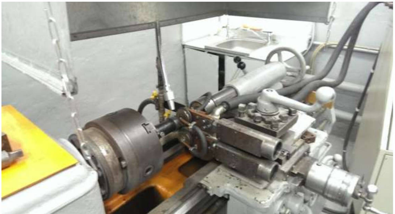
Рисунок 2.16 – Общий вид инструментальной оснастки, установленной на токарно-винторезный станок.
