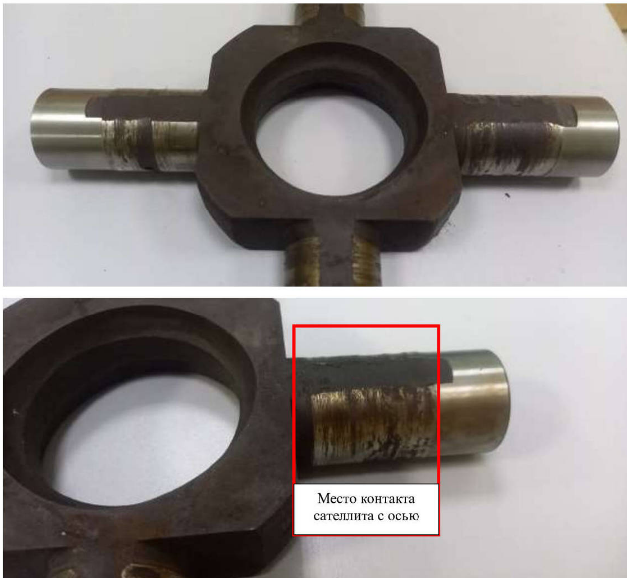
Рисунок 1.16 – Износ оси сателлитов переднего моста специального колесного шасси, в следствии нарушения скоростей движения.
