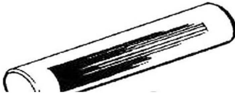
Рисунок 1.8 – Износ поверхностей пальца гусеничного звена
