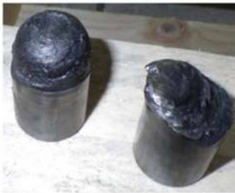
Рисунок 1.18 – Разрушение всех осей крестовины сателлитов дифференциала первого ведущего моста.
