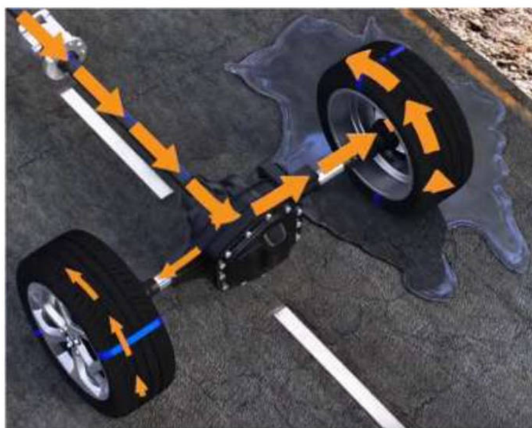
Рисунок 1.15 – Буксование правого колеса автомобиля на скользкой дороге.
