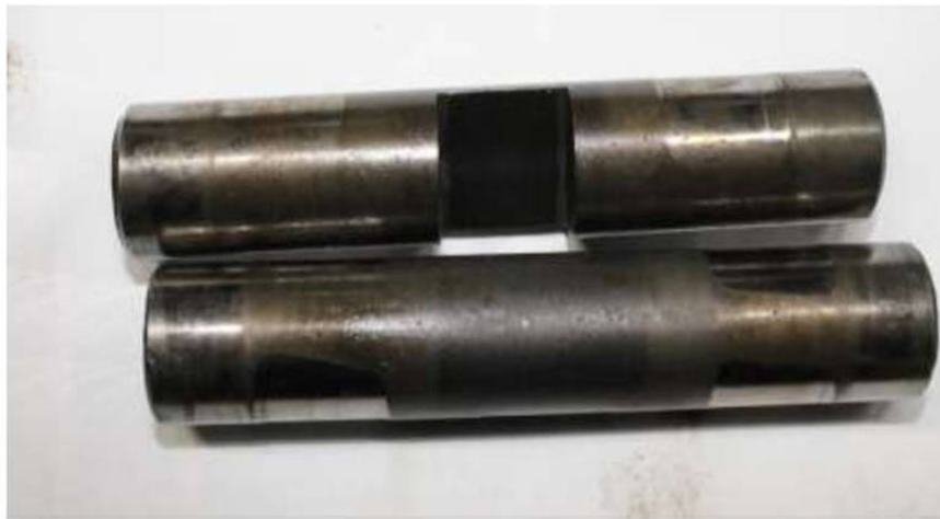
Рисунок 6.3 – Ось сателлита дифференциала.
