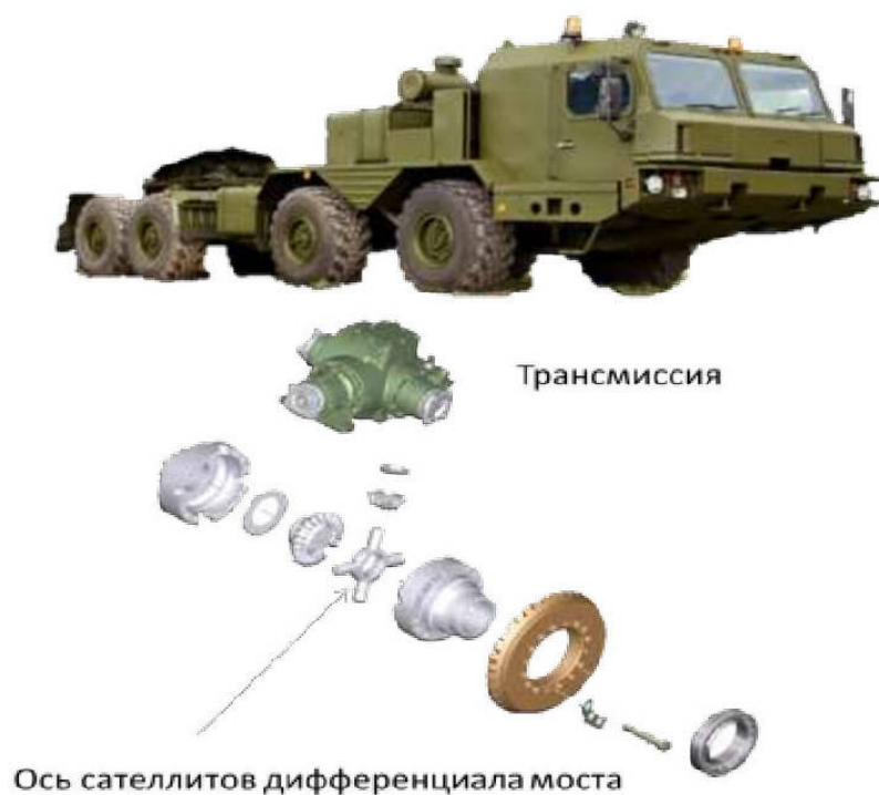
Рисунок 6.1 – Пара трения «сателлит – ось сателлита» в сборе
