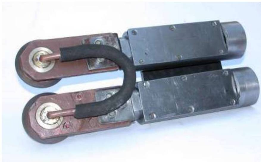
Рисунок 2.14 – Инструментальная оснастка при электромеханической обработке
