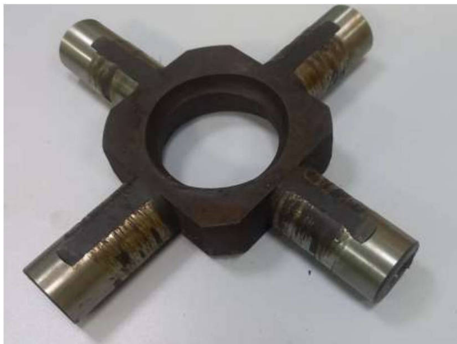
Рисунок 1.2 – Износ осей сателлитов
